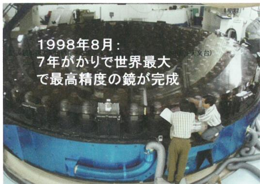
図1 米国ピツツバーグ近郊の光学会社施設での、すばる望遠鏡の主鏡完成検査（1998年8月28日）
